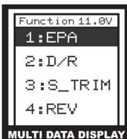
Настройка конечных точек (EPA) - Используется для настройки максимального расхода желаемой функции в диапазоне 0-120%. Может быть использована в обоих направлениях расхода (вперед/назад и влево/вправо) для настройки общей величины перемещения. Может использоваться в сочетании со сдвоенным расходом (D/R).
