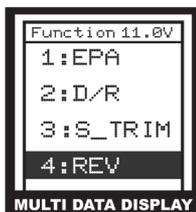
Реверс - REVERSE (REV) - Эта функция используется для реверса направления сервопривода или регулятора скорости.
