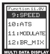
Эта функция позволяет установить скорость сервоприводов газа и рулевого управления. В меню скорости руля, можно установить скорость поворота и скорость возврата.
