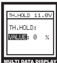
Для использования этой настройки во время запуска модели, нажмите кнопку **TH. HOLD**, расположенную слева от курка газа. Это включит функцию **TH. HOLD** и установит газ в предустановленное положение. Для выключения функции **TH. HOLD**, нажмите кнопку еще раз, это восстановит нормальную работу курка газа.
