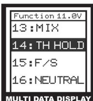
Функция холостого хода позволяет установить сервопривод газа в процент от полного расхода. Это является альтернативой нажатию на газ при запуске двигателя модели. Эта функция блокирует нормальное использование канала газа до повторного нажатия кнопки **TH. HOLD** на передатчике. Убедитесь, что установленное значение достаточно только для поддержания холостого хода двигателя во время запуска и прогрева. **ПРИМЕЧАНИЕ:** Установка слишком большого значения может привести к убою модели.
