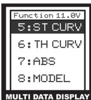
Кривая руля (ST. CURVE) - Кривая руля используется для изменения чувствительности рулевого сервопривода около нейтрального положения, без влияния на максимальный расход. Эта возможность полезна для успокоения моделей с чувствительным рулевым управлением. Для новой модели начните с 0% и до получения желаемого результата.
